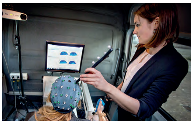
Meting van hersenactiviteit gecombineerd met een haptische robot in een hiervoor ontwikkelde mobiele meetbus die naar verblijf van de patiënt toegaat. Foto Digidaan
